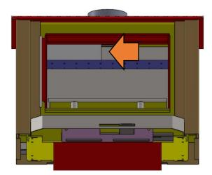
PUSH THE BAFFLE PLATE SIDE WAYS UNTIL IT IS AGAINST THE SIDE WALL. THEN PULL IT FORWARD AND LET IT REST ON THE FRONT TAB. THIS WILL ALLOW FOR MORE ROOM FOR THE OTHER BAFFLE PLATE.
