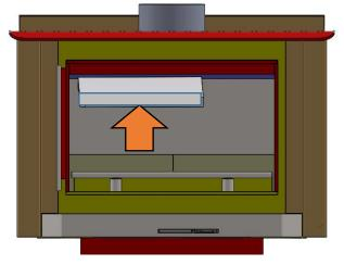
SLIDE THE BAFFLE PLATE ON A SLIGHT ANGLE TOWARDS THE BACK OF THE UNIT. MAKE SURE TO PLACE ABOVE THE AIR TUBE, PUSH BACK AS FAR AS POSSIBLE.
